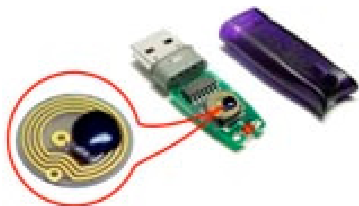
Rys. Umieszczony moduł zbliżeniowy RFID na eTokenie, pozwalając wykorzystać go jako identyfikator do systemów kontroli dostępu (KD) oraz rejestracji czasu pracy (RCP).
